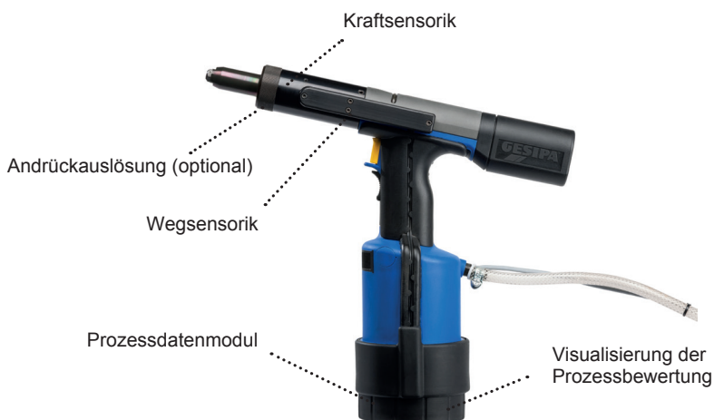
Abbildung 1: Prinzipaufbau Taurus mit Setzprozessüberwachung
